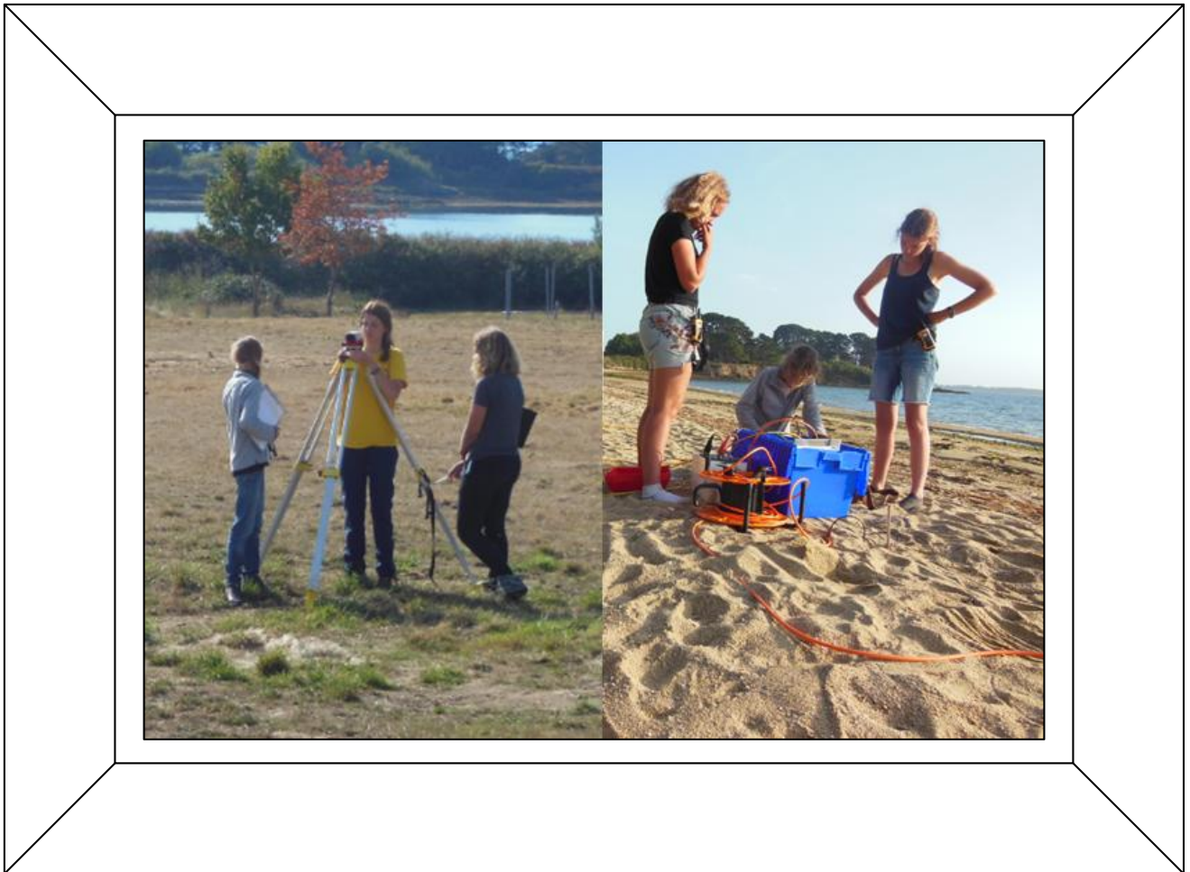
Figure 2 : Utilisation et manipulation des outils de terrain (nivellement des profils électriques à gauche et réglage des outils géophysiques à droite) - Source personnelle
